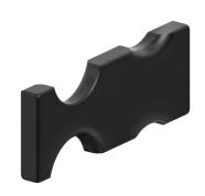
Il dispositivo di tensionamento PolyVee permette di tendere con facilità le cinghie PolyVee a 2 e 3 gole ed è pensato per passi fra i rulli di 75 mm e 100 mm. Il dispositivo di tensionamento è progettato per rulli e RollerDrive con un diametro di 50 mm. Non può essere utilizzato con i tubi dotati di guaina di rivestimento o con elementi conici.
