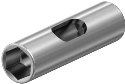
Die Befestigungsnuss dient zum drehmomentsicheren Anziehen der RollerDrive-Befestigungsmutter mit Hilfe eines Drehmomentschlüssels. Die Nuss verfügt über eine seitliche Öffnung, über die die RollerDrive-Anschlussleitung hinausgeführt werden kann.
