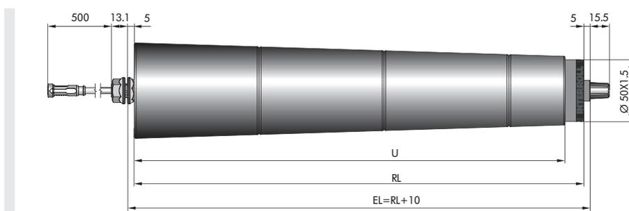
\* Aquí no se representa la fijación mediante rosca interior, pero presenta las dimensiones (RL/EL) del eje hexagonal con muelle representado.
