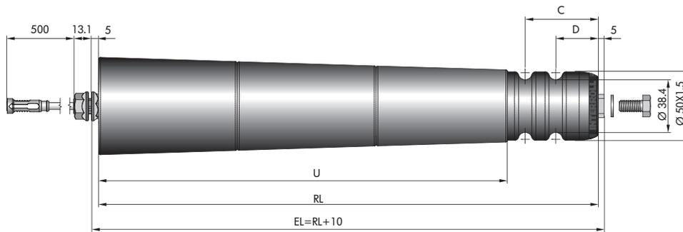
\* Aquí no se representa la fijación mediante eje hexagonal con muelle (eje cónico), pero presenta las dimensiones (RL/EL) de la solución de fijación por rosca interior representada.
